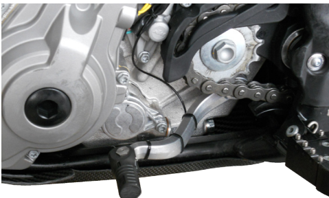
Photos du montage du kit EQS Easy Quick Shifter sur levier d'origine. Ce capteur est repliable et parfaitement adapté à la majorité des modèles typés cross, supermotard ou enduro, 2 tps ou 4 tps.
