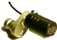
Capteur sur levier en prise directe (sans tige de sélecteur) d'origine (Aprilia / MV Augusta)
