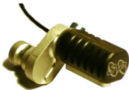
Capteur sur levier en prise directe (sans tige de sélecteur) d'origine (Aprilia / MV Agusta)
